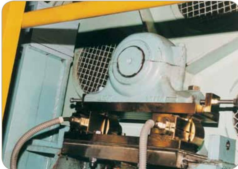
Nelle misure di tiro (web tension), la forma cilindrica permette di ruotare la cella nel suo afferraggio per misurare la forza risultante.
